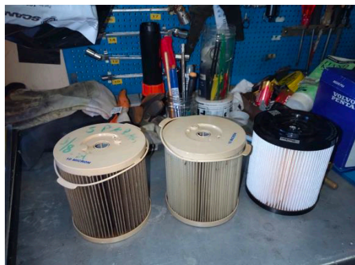
Bränslefilter. Använt filter vid dieseldrift tv, filter efter HVO 100 drift i mitten samt helt nytt filter th.
